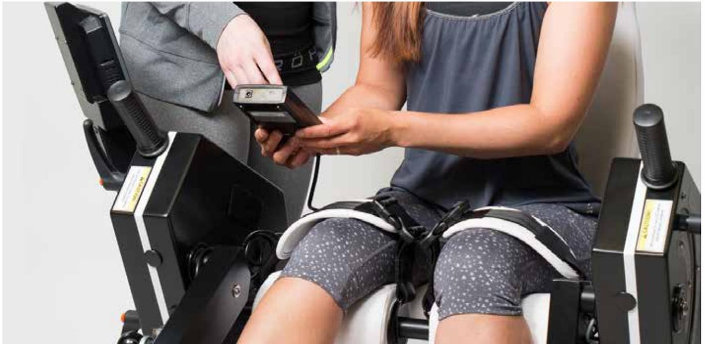
Der **HUR Performance Recorder** ist ein tragbares Messgerät zur Ermittlung der isometrischen Maximalkraft. Er kann direkt an alle HUR-Trainingsgeräte angeschlossen werden, die über einen Sensoranschluss für den Isometrietest verfügen. Die Testergebnisse werden direkt über den Gerätebildschirm in die SmartTouch Software übertragen. Zusätzlich wird eine Analysesoftware für analoge HUR Trainings mitgeliefert.
