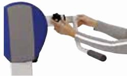
**29. Sensoranschluss für isometrisches Testen (4254)**
