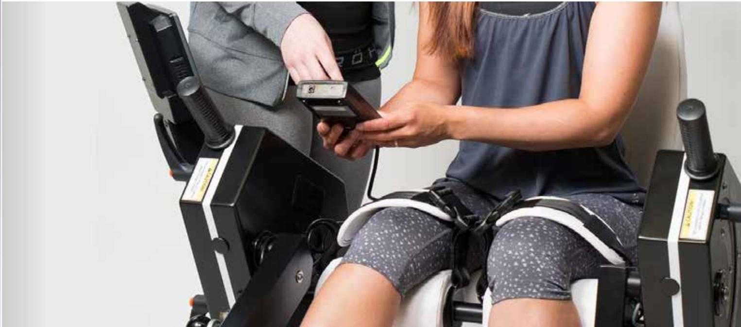
Der **HUR Performance Recorder** ist ein tragbares Messgerät zur Ermittlung der isometrischen Maximalkraft. Er kann direkt an alle HUR-Trainingsgeräte angeschlossen werden, die über einen Sensoranschluss für den Isometrietest verfügen. Die Testergebnisse werden direkt über den Gerätebildschirm in die SmartTouch Software übertragen. Zusätzlich wird eine Analysesoftware für analoge HUR Trainings mitgeliefert.
